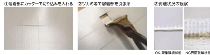
ブルーフ工法では、必ず現場で事前溶着テストを行い、設定温度を決めてから熱溶着防水を行っていますので、設計条件及び施工現場に合った理想的な工事が実施できます。
