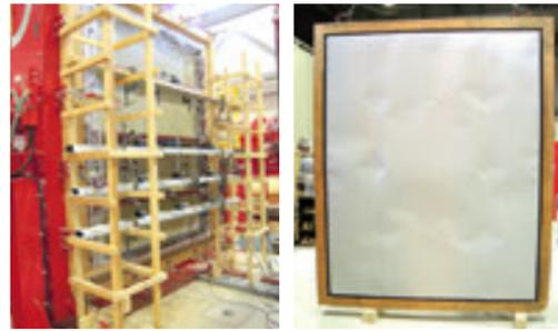
鋼板を機械的にドリルビスで固定するため、めくれが無く、耐風圧性に優れています。公的機関で試験を行い、6,000Paでも破損しませんでした。(強度計算はお問合せください。)
